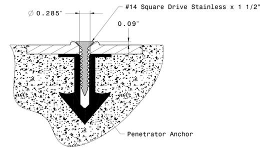
TYPICAL INTERIOR FASTENER DETAIL
